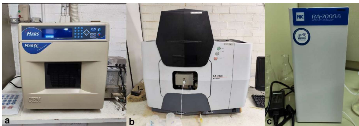
Figura 3. Liofilização de amostras em forno de micro-ondas (a); quantificação de metais traço (Zn, Cu, Cd, Pb) em um espectrômetro de absorção atômica convencional por chama (b); analisador de mercúrio (Hg) por espectrofotometria atômica de vapor frio (c).
