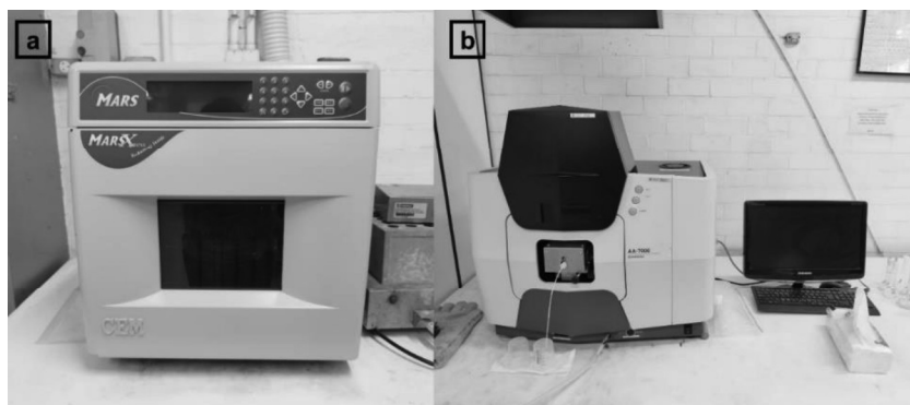
Figura 3. a) Equipamento de micro-ondas. b) Espectrômetro de absorção atômica por chama, utilizados na preparação (a) e quantificação de metais (b) nas amostras coletadas.
