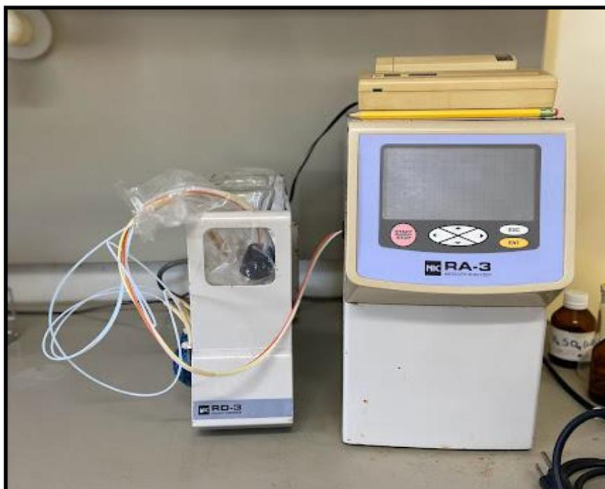
Figura 6. Equipamento de Espectrometria de Absorção Atômica com sistema de geração de vapor frio (CVAAS).
